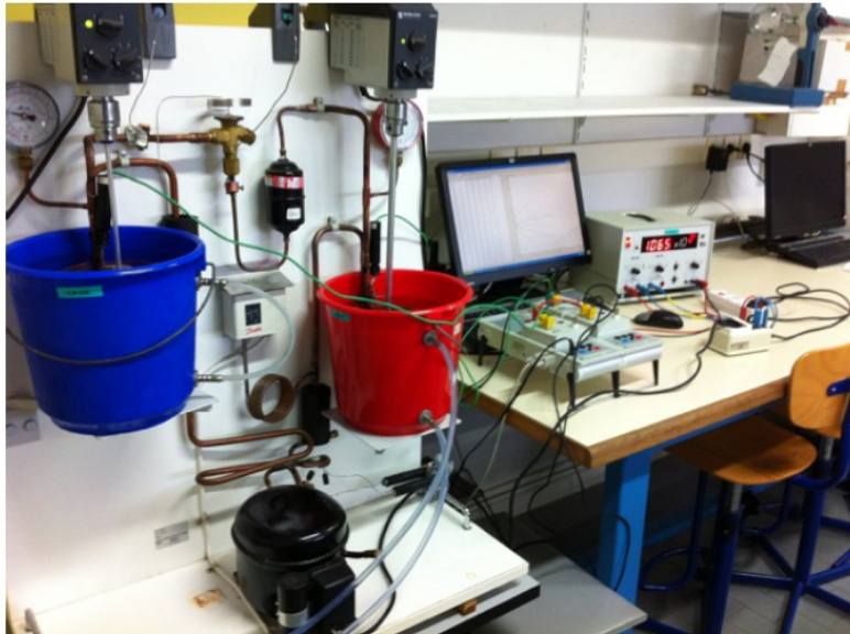
Pompe à chaleur avec dispositif d'acquisition
