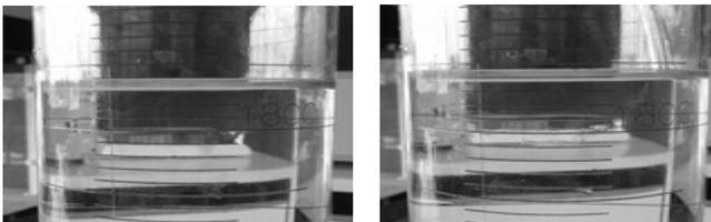
La surface de l'eau sert de référence pour la mesure de la profondeur, mais elle se déplace lorsque le flexible est introduit dans l'eau...
