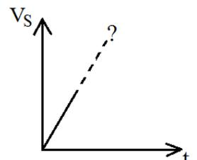
Condition initiale  $V_s(0)=0=K$  donc  $V_s(t)=\frac{V_{sat}}{R_3 C} t$  (allure ci-contre)
