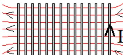
3) On estime  $l \sim 3$  cm à partir du diamètre de la vis.  $\|\vec{B}\| = \mu_0 \frac{N}{l} I \approx 2 \cdot 10^{-2} \text{ T} \approx 20 \text{ mT}$
