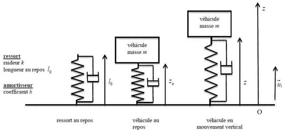
Suite à une impulsion soudaine ( $v(t=0) = v_0 > 0$ ), le véhicule initialement immobile acquiert un mouvement d'oscillations verticales. On cherche à établir l'équation différentielle caractéristique du mouvement par une méthode énergétique.
