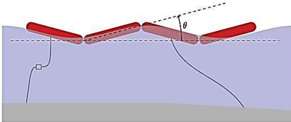
On note  $\theta$  l'angle entre un flotteur et l'horizontale. Il subit de la part de ses voisins deux couples. Un couple de rappel élastique  $-C\theta$  et un couple résistant  $-\beta\dot{\theta}$  qui entraine une génératrice. Sur chaque flotteur s'exerce de plus un couple moteur dû à la houle :  $\Gamma_0 \cos \omega t$ . On note  $J$  le moment d'inertie d'un cylindre par rapport à son centre que l'on supposera fixe.
