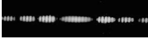
2) Entre les photodiodes numérotées 280 et 720, on compte 5 interfranges. La longueur occupée par une photodiode vaut  $L_p = L/N = 3,91 \cdot 10^{-5}$  m, on a donc  $5i = 440 \cdot L_p$  soit  $i = \frac{440 \cdot L}{5N} = 3,44$  mm
