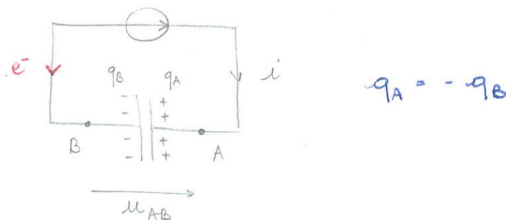
L'accumulation de charges opposées sur les armatures fait apparaître une tension aux bornes du condensateur. L'intensité  $i$  et la tension  $u_{AB}$  évoluent au cours du temps : le circuit est en régime transitoire.
