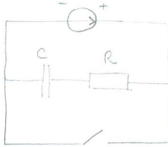
À  $t = 0$ , le condensateur est chargé et on ferme l'interrupteur :
