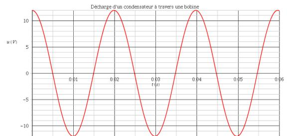
L'énergie emmagasinée sous forme d'énergie électrique dans le condensateur lors de sa charge, est transférée à la bobine lors de la décharge du condensateur : cette énergie est stockée dans la bobine sous forme d'énergie magnétique. Puis le condensateur se charge à nouveau et l'énergie est retransférée dans le condensateur ... Il n'y a aucune perte d'énergie lors de ces transferts d'énergie : les oscillations ne sont donc pas amorties.
