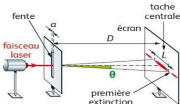
Pour un faisceau de longueur d'onde  $\lambda$  traversant une fente de largeur  $a$ , la demi-ouverture angulaire  $\theta$  s'exprime :
