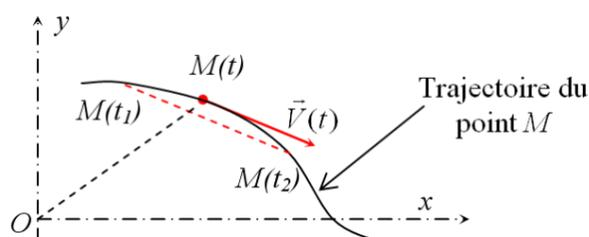
Dans de nombreuses situations, les grandeurs instantanées en un point M sont calculées, par approximation, à partir de grandeurs moyennes calculées entre 2 points pris les plus proches possible du point d'étude M (par exemple  $M_1$  et  $M_2$ ). Ainsi pour la vitesse instantanée au point M, on utilise la formule :
