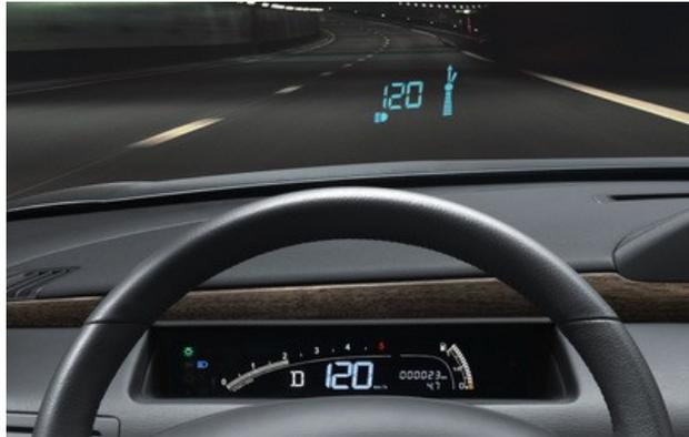
Figure 1. Vue du tableau de bord d'un véhicule muni de l'affichage tête haute
