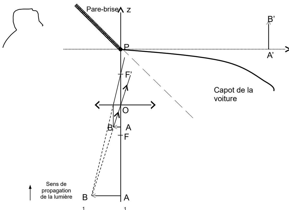
Figure 3. Schéma du dispositif d'affichage tête haute
